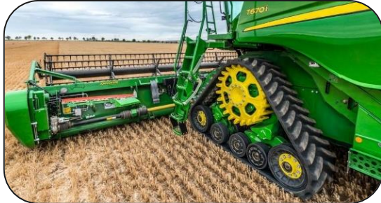
Bodenschonender Raupenantrieb (Quelle: UFA-Revue2020)
